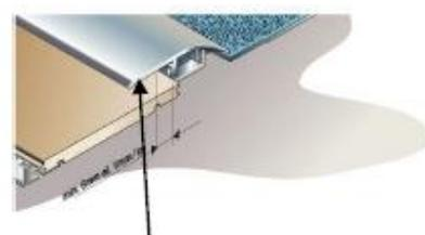
Если используются погонажные детали, нанесите неотверждаемый герметик на верхнюю часть поверхности, которая будет закрыта погонажной деталью. Нанесите столько неотверждаемого герметика, чтобы он выступал из-под погонажной детали при ее укладке на место. Подождите 15-25 минут и удалите выступивший герметик (смотрите рисунки 1, 2 и 3).
